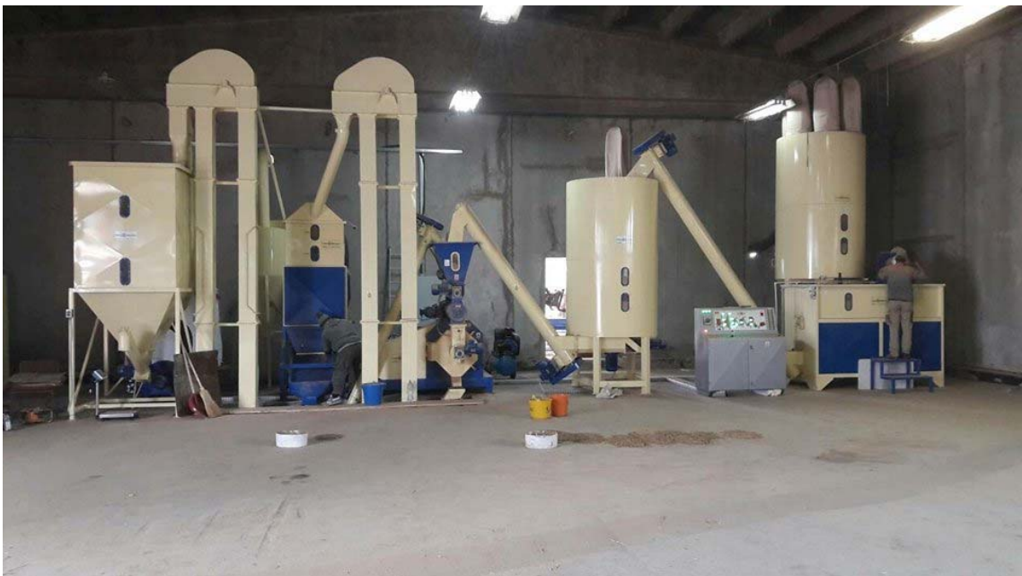
Slika 6. Proizvodna linija za dobivanje agro peleta [15]
