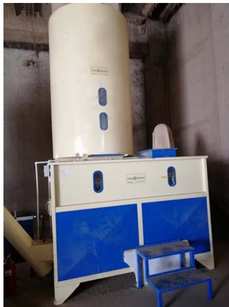
Slika 10. Mlin sa sitom od 8 mm [15]
