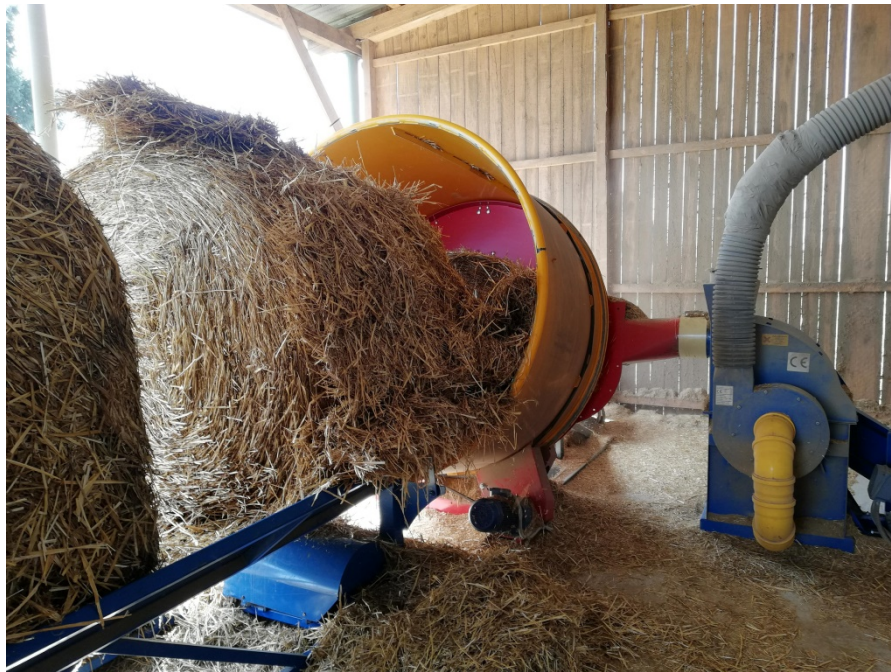
Slika 9. Stroj za usitnjavanje slame [15]
