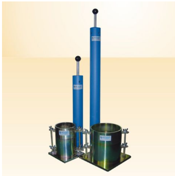
Slika 12. Uređaj za Proctor-ov pokus
