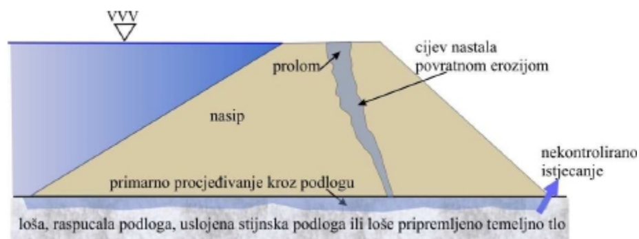
Slika 30. Povratna erozija kroz nasip uslijed ispiranja temeljnog tla [3]
