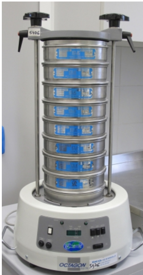
Slika 17. Tresilica s garniturom sita
