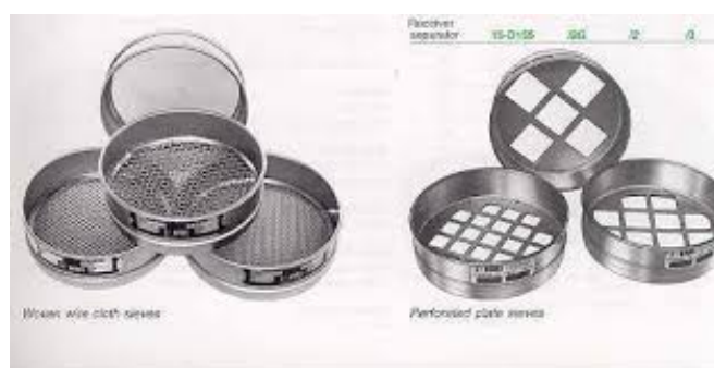
Slika 16. Sita za sijanje
