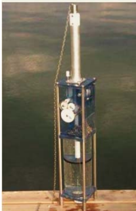
Slika 10. Uzorkivač na ispiranje [23]
