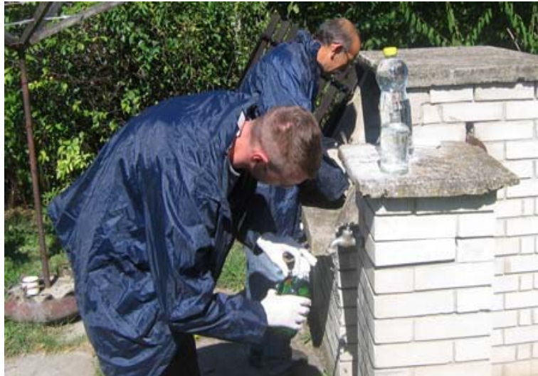
Slika 7. Uzimanje uzoraka vode iz zdenca [20]
