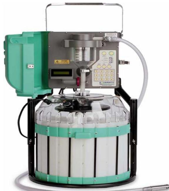
**Slika 11.** Automatski uzorkivač
