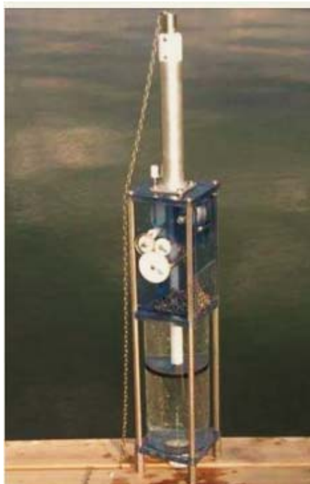
Slika 10. Uzorkivač na ispiranje [23]
