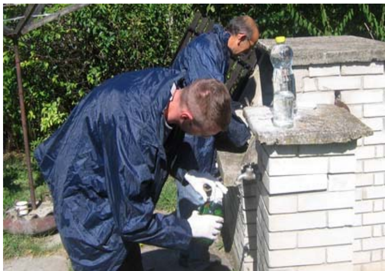
Slika 7. Uzimanje uzoraka vode iz zdenca [20]
