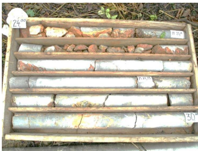
Slika 3 Primjer jezgre bušotine BJL-3 na lokaciji Bjelolasica (Meaški, 2017a)
