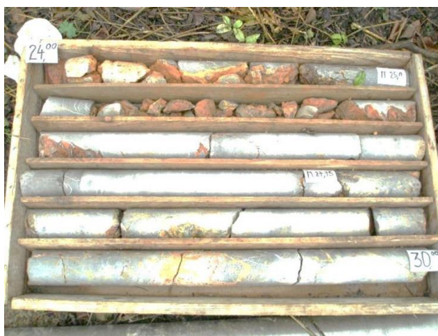
Slika 10 a) Primjer pukotina uzduž jezgre; b) Jezgra bušotine (H. Meaški)
