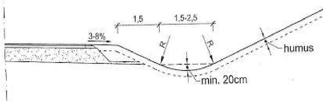
Slika 4. Odvodni jarak (segmentnog oblika) (Dragčević i Rukavina, 2006)
