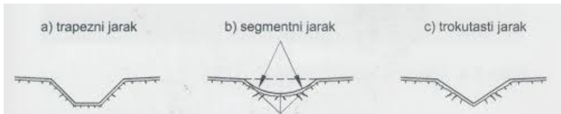
Slika 2. Poprečni presjeci jarka (Dragčević i Rukavina, 2006)
