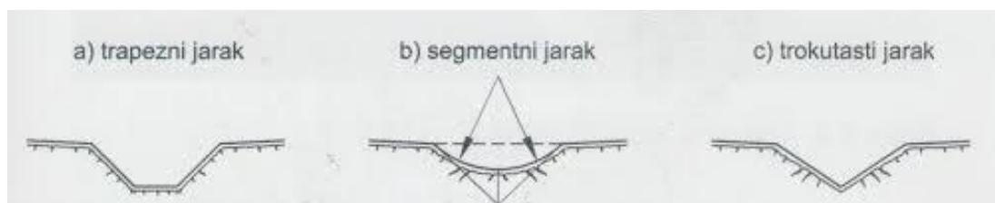
Slika 2. Poprečni presjeci jarka (Dragčević i Rukavina, 2006)
