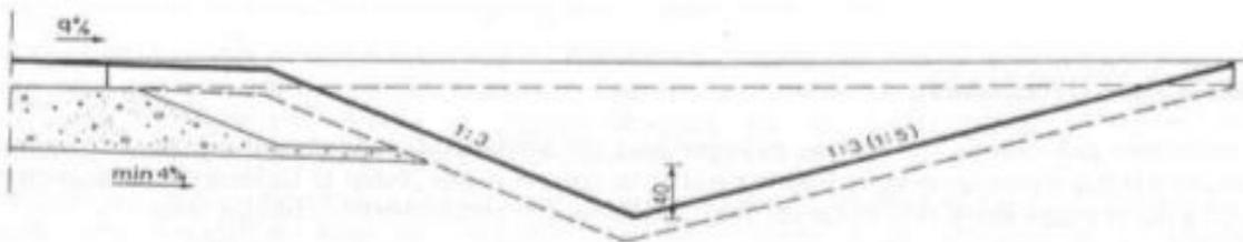
Slika 5. Odvodni jarak (trokutastog oblika) (Dragčević i Rukavina, 2006)
