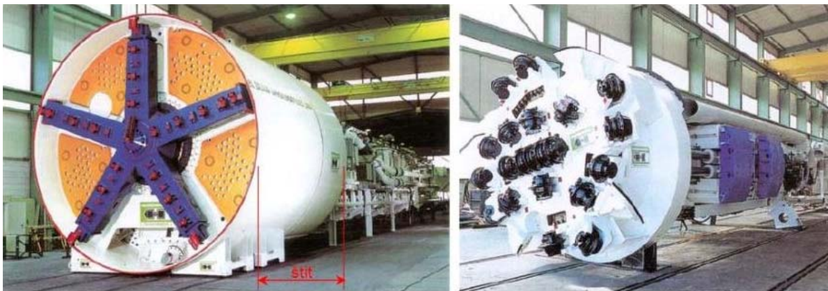
Slika 7.2 Stroj sa i bez štita
