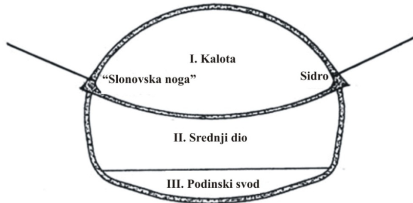
Slika 6.1 Iskop u tri faze [8]
