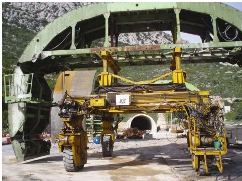
Slika 9.8 Samohodna hidraulična oplata [10].
