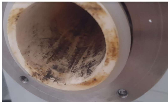
Slika 15: Vakuumska peć iznutra nakon eksplozije
