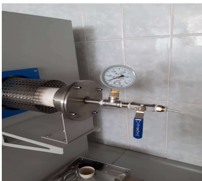
Slika 8: Ventil pomoću kojeg se upuhuje dušik
