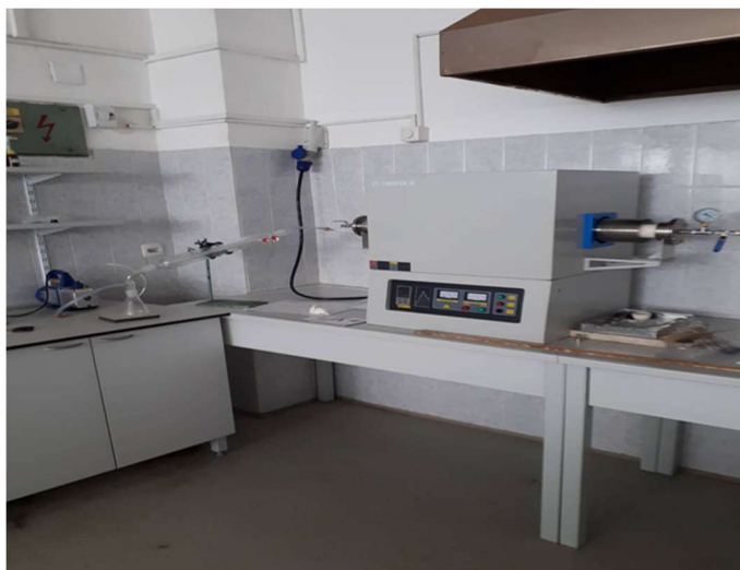
Slika 5: Vakuumska peć modela ST-1400CGV-II koja je korištena u pokusu
