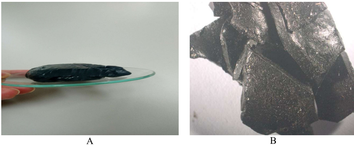
Slika 12: Prikaz uzorka mulja prije (A) i nakon (B) vakuumske pirolize
