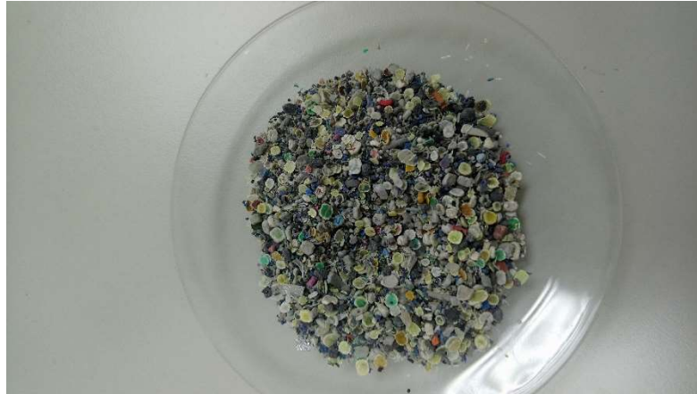
Slika 14: NMF tiskane pločice prije vakuumske pirolize
