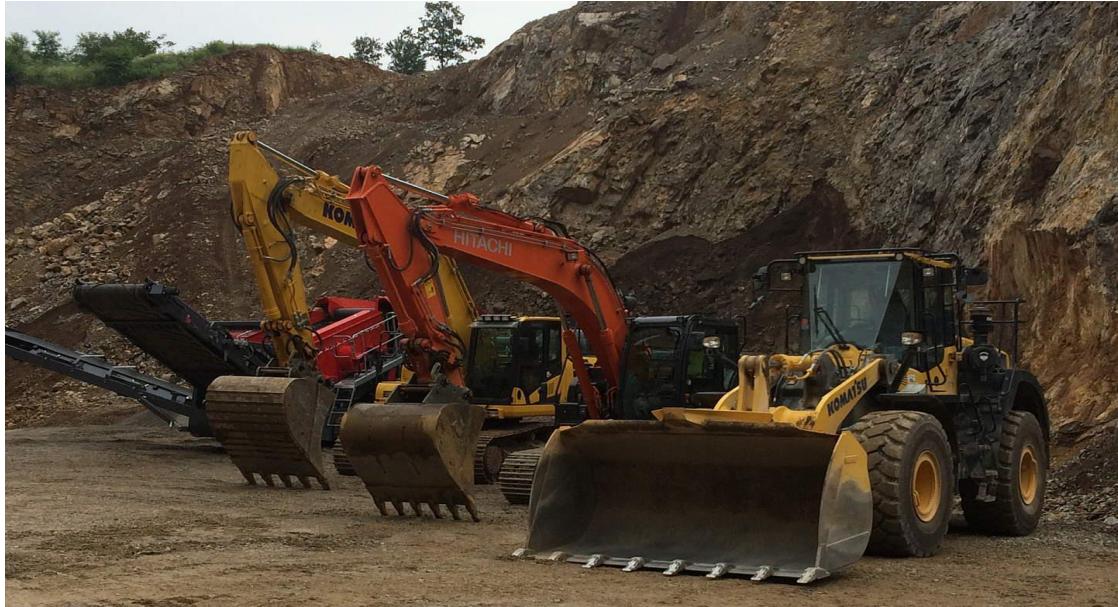
Slika 5.2 Bageri gusjeničari cikličkog načina rada i utovarivač [4]
