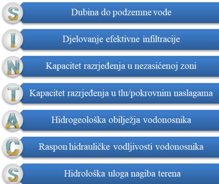
Slika 2.1. Parametri procjene ranjivosti prema SINTACS metodi
