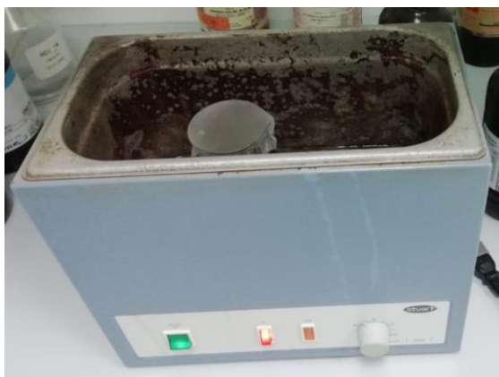
Slika 16: Digeriranje uzorka u vodenoj kupelji
