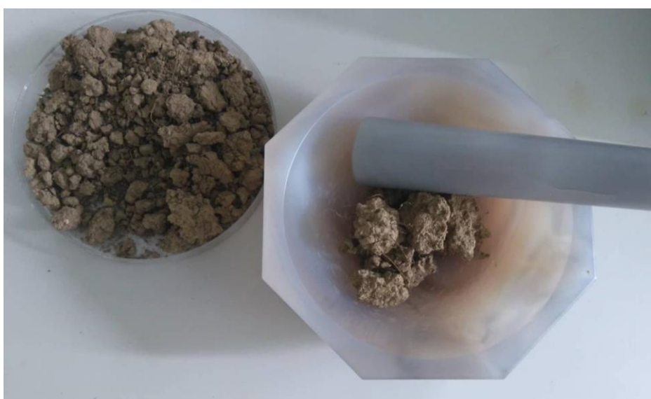
Slika 10: Usitnjavanje uzorka pomoću tarionika i tučka
