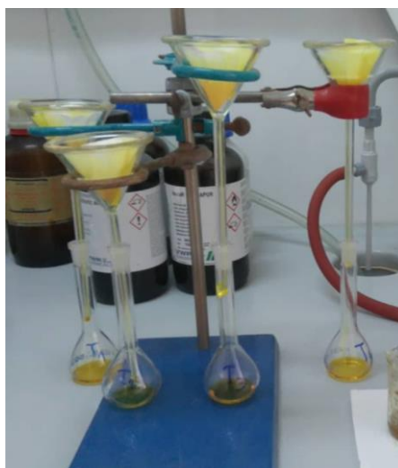
Slika 14: Filtracija eluata preko filter papira promjera pora 0,45 \mu\text{m}
