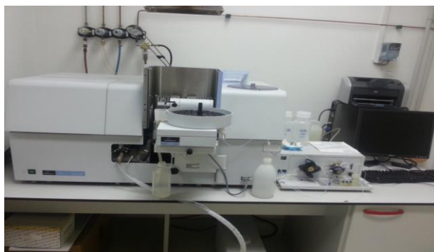
Slika 18: Atomski emisijski spektrometar, Analyst 800 tvrtke PERKIN ELMER
