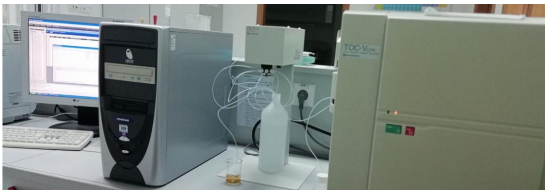
Slika 15: TOC/TN analizator tvrtke SHIMADZU
