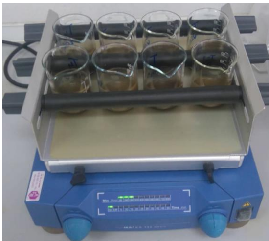
Slika 11: Mješanje uzoraka orbitalnom miješalicom
