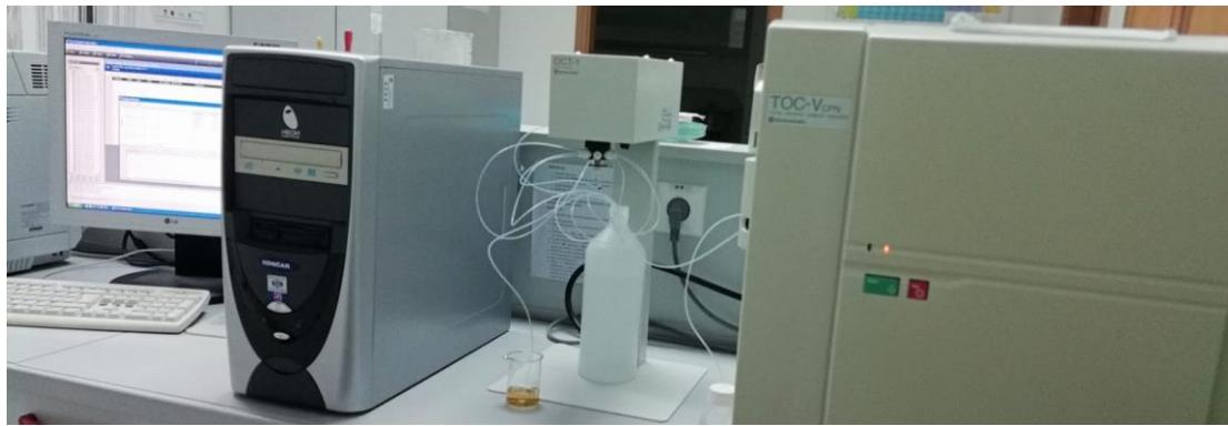
Slika 15: TOC/TN analizator tvrtke SHIMADZU
