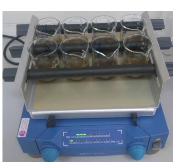
Slika 11: Mješanje uzorka orbitalnom mješalicom
