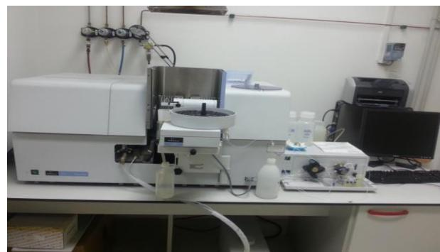
Slika 18: Atomski emisijski spektrometar, Aanalyst 800 tvrtke PERKIN ELMER
