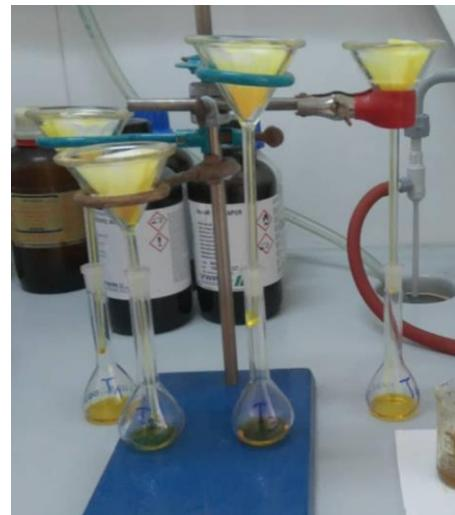
Slika 14: Filtracija eluata preko filter papira promjera pora  $0,45 \mu\text{m}$
