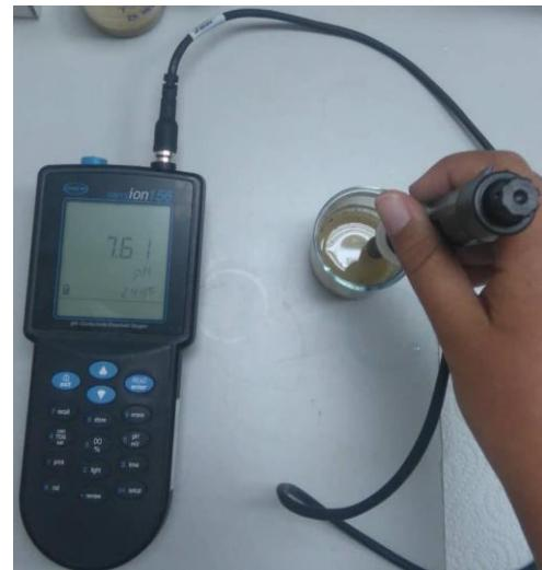
Slika 12: Mjerenje uzorka multimetrom
