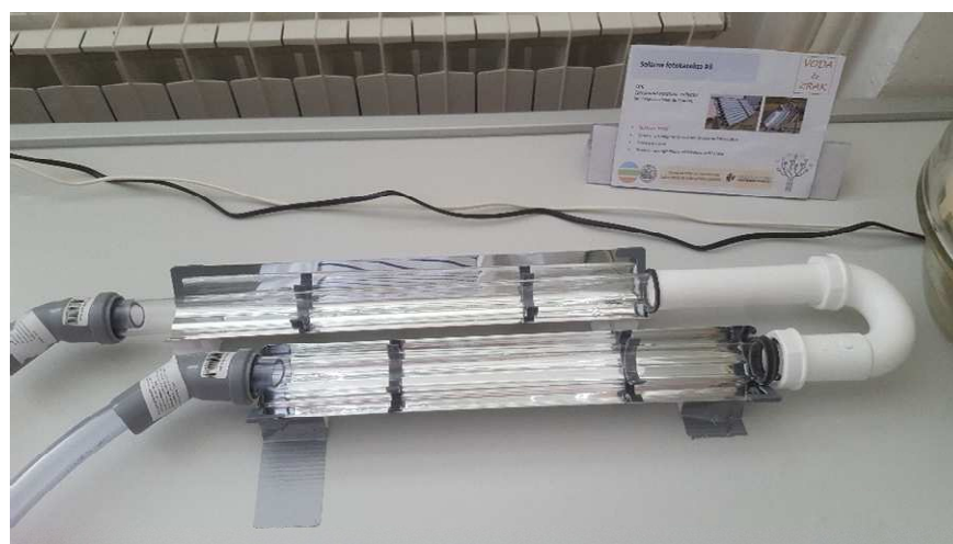
Slika 40 CPC reaktor u Laboratoriju za inženjerstvo okoliša Geotehničkog fakulteta
