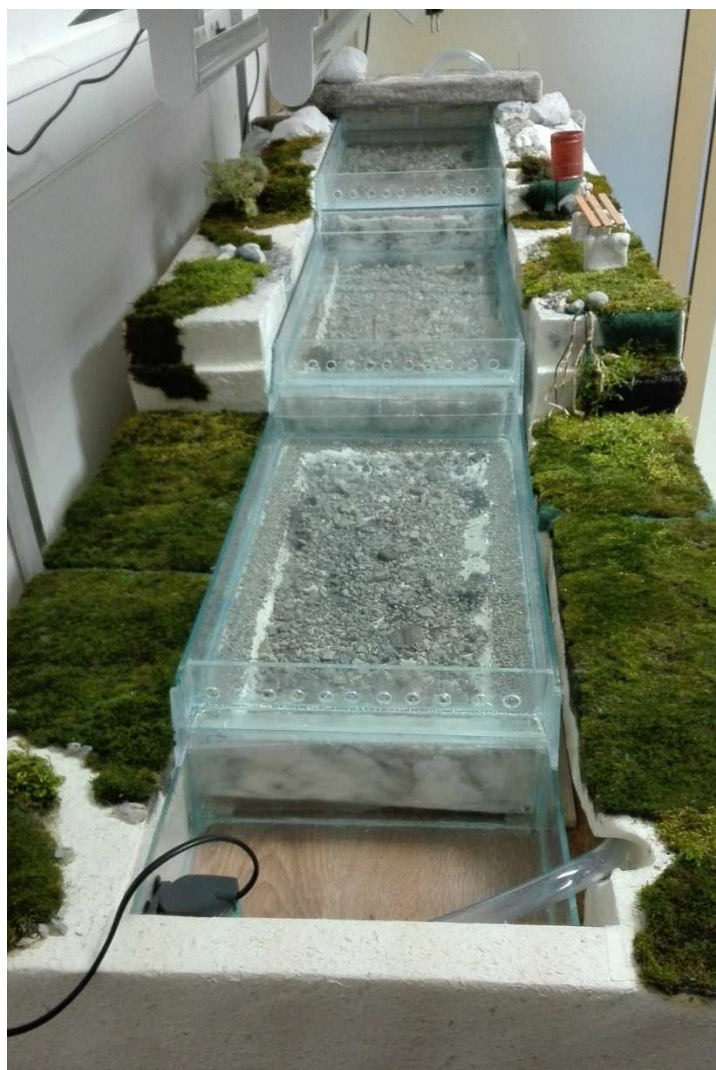
Slika 24 Eksperimentalni sustav pločastog kaskadnog reaktora Geotehničkog fakulteta
