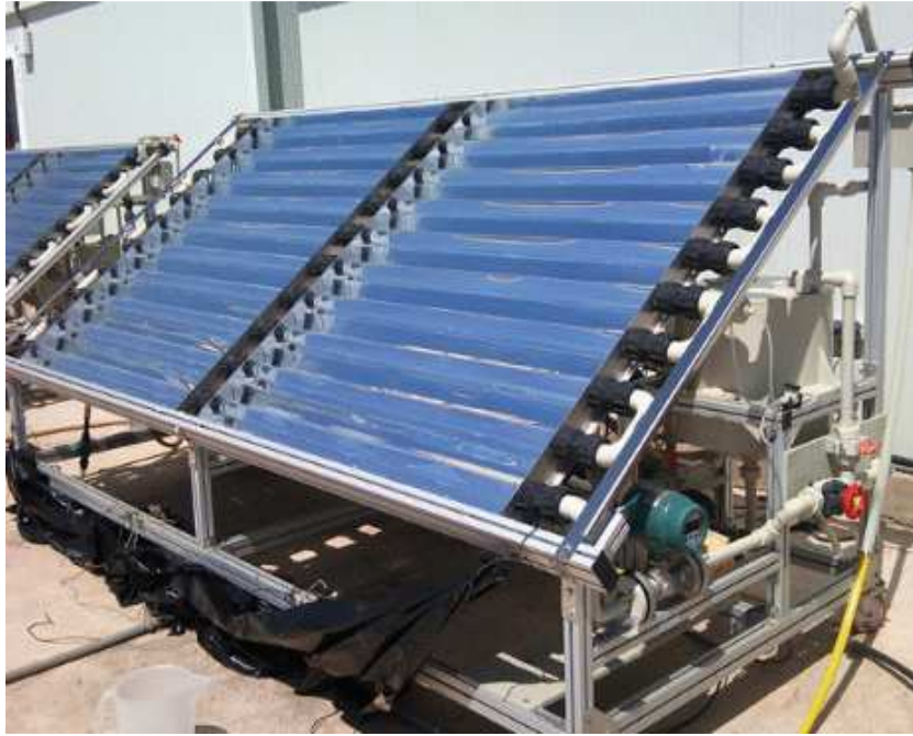
Slika 26 CPC reaktor „FITOSOL“ [46]
