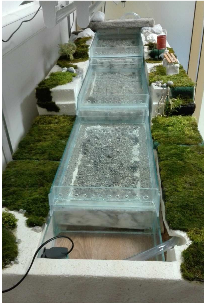
Slika 24 Eksperimentalni sustav pločastog kaskadnog reaktora Geotehničkog fakulteta
