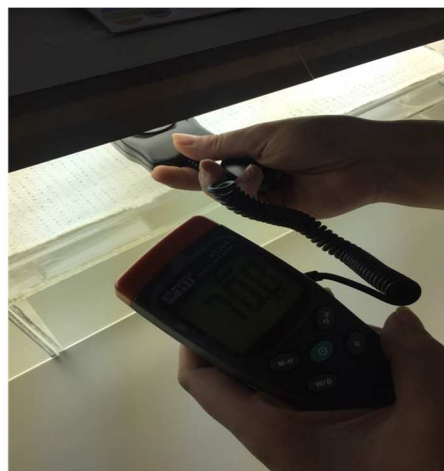
Slika 9. Prikaz solarimetra HT204 i mjerenje intenziteta zračenja
