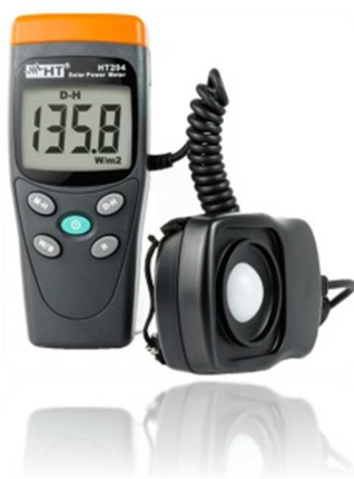
Slika 9. Prikaz solarimetra HT204 i mjerenje intenziteta zračenja
