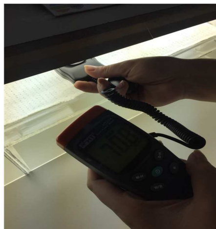
Slika 9. Prikaz solarimetra HT204 i mjerenje intenziteta zračenja
