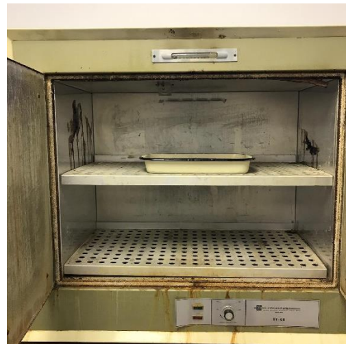
Slika 13. b) Sušenje uzorka u sušioniku
