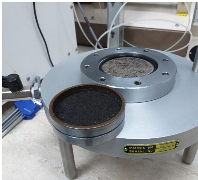
Slika 14. Slijeganje uzorka nakon provedenih ispitivanja
