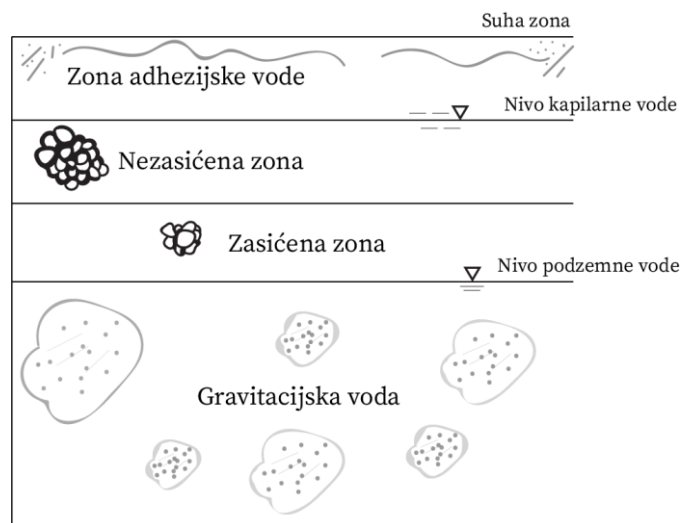
Slika 3. Gravitacijska i kapilarna voda u tlu
