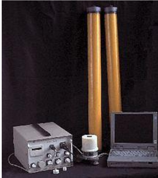
Slika 35. Uređaj za mjerenje metodom magnetotelurika
