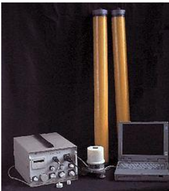
Slika 35. Uređaj za mjerenje metodom magnetotelurika
