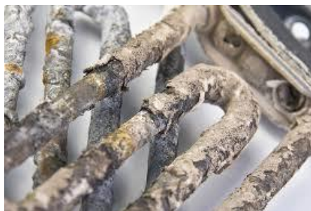
Slika 7. Taloženje kamenca na cijevima
