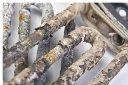
**Slika 7.** Taloženje kamenca na cijevima
