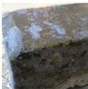
Slika 27. Kamen premazani titanijevim dioksidom [28]
