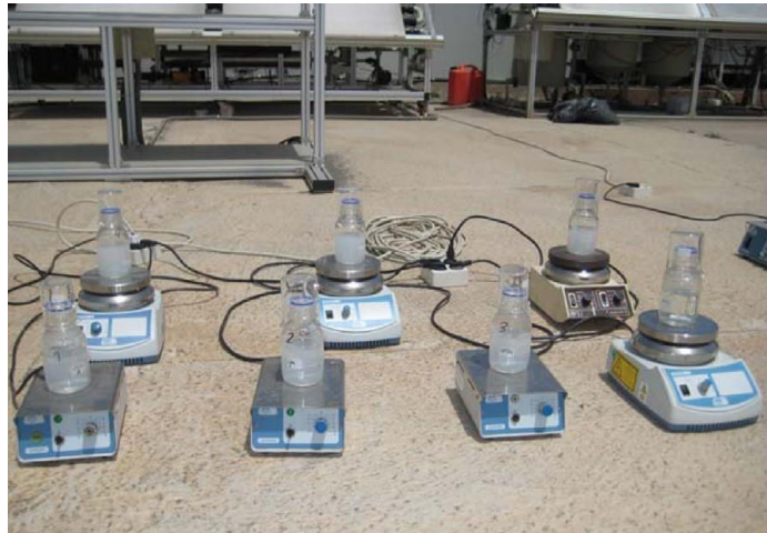
Slika 20. Fotokatalitička postava za inaktivaciju E. coli.[23]
