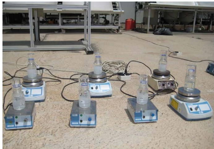
Slika 20. Fotokatalitička postava za inaktivaciju E. coli.[23]
