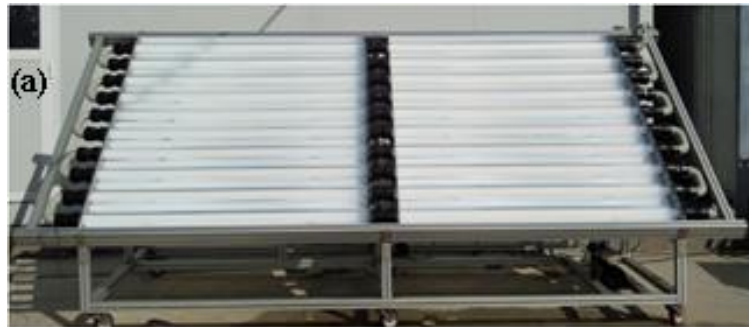
Slika 23. Korišteni CPC foto- reaktor [26]
