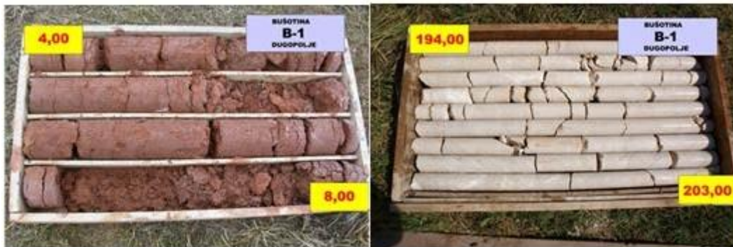
Slika 20. Primjer izvađene jezgre [25]
