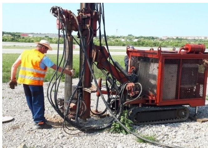
Slika 18. Istražno udarno bušenje [27]
