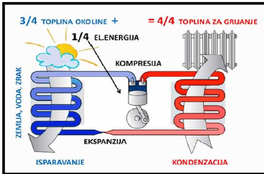
Slika 14. Shematski prikaz rada dizalice topline/toplinske pumpe. [5]
