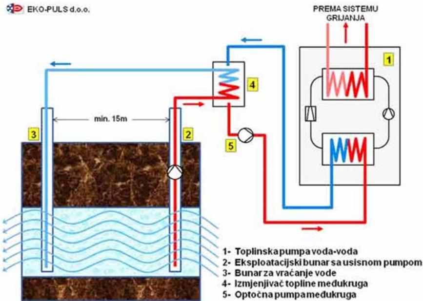
**Slika 2.** Shematski prikaz rada dizalice topline voda-voda. [4]
