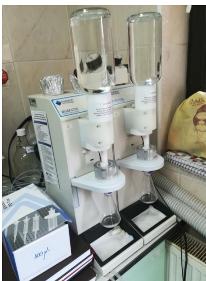
Slika 13. Automatizirani sustav za ekstrakciju
