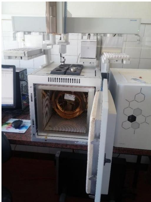
**Slika 12.** Kolona Rtx-502.2 smještena u termostatiranoj pećnici
