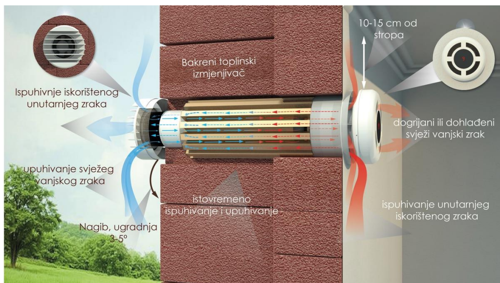
Slika 13. Shema djelovanja rekuperatora topline [16]
