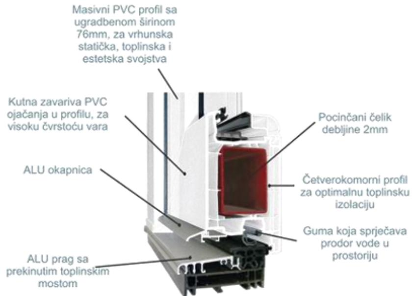
Slika 10. Prikaz poprečnog presjeka vrata pasivne kuće [12]
