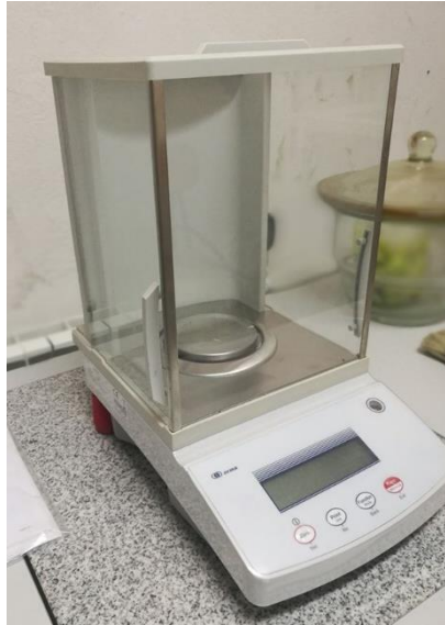
Slika 10 Analitička vaga Orma ALR-224
