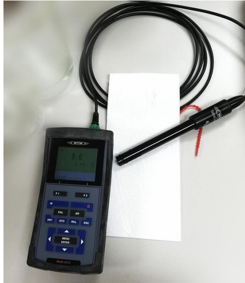
Slika 12 Više-parametarski mjerni instrument MultiLine® Multi 3410 IDS
