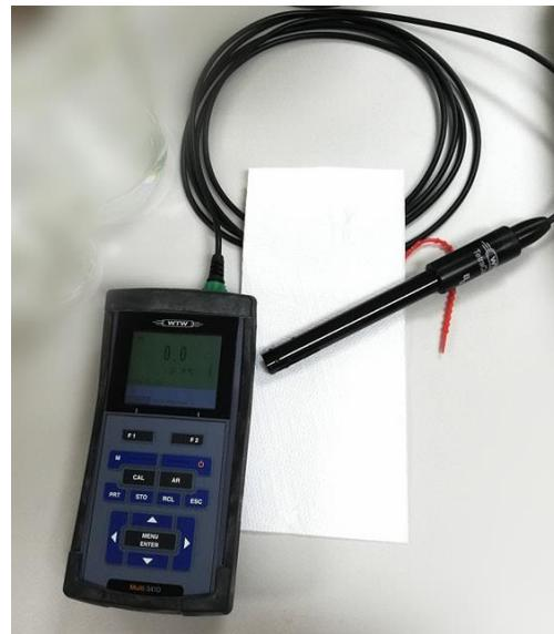
Slika 12 Više-parametarski mjerni instrument MultiLine® Multi 3410 IDS
