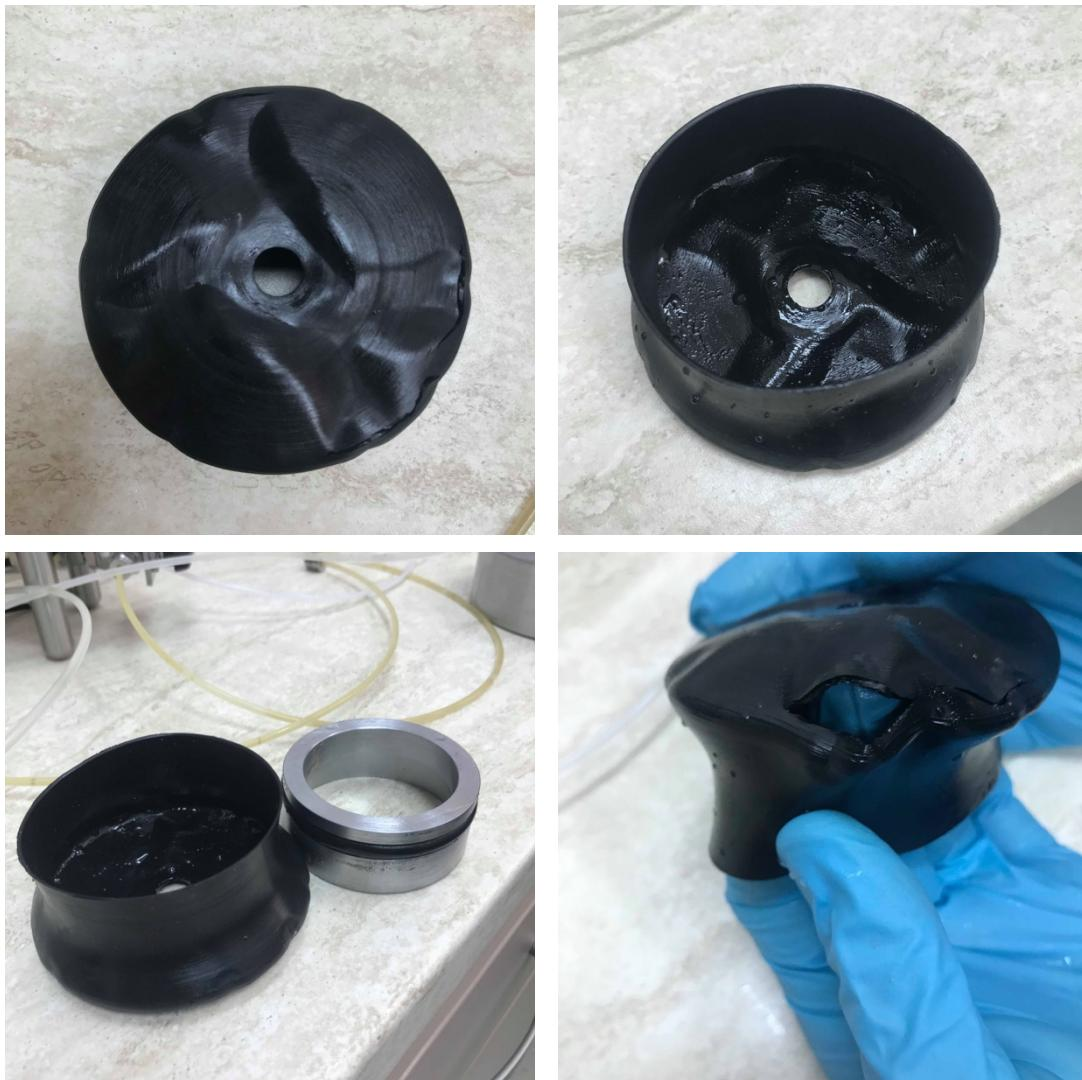
*Slika 28 Deformacija i puknuće gumene membrane*
