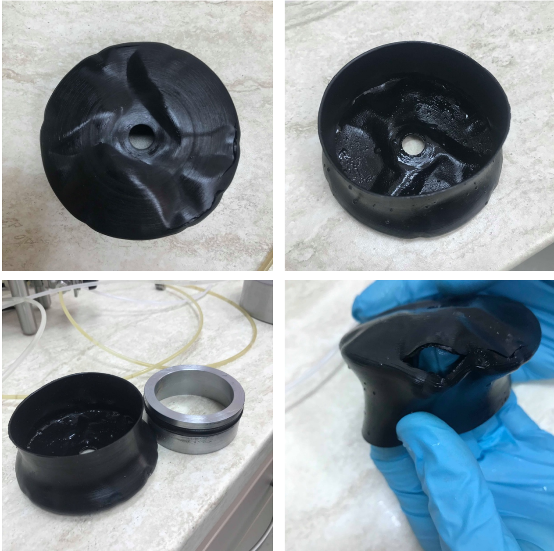
Slika 28 Deformacija i puknuće gumene membrane
