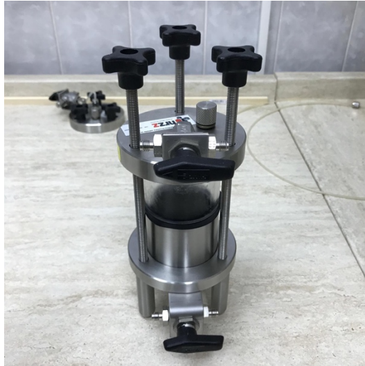
Slika 17 Sastavljena toksična ćelija
