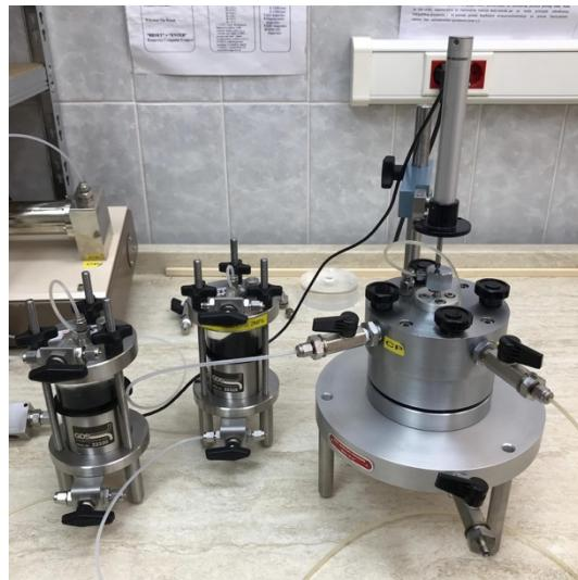
*Slika 26 Sastavljeni hidraulički edometar s toksičnim čelijama*
