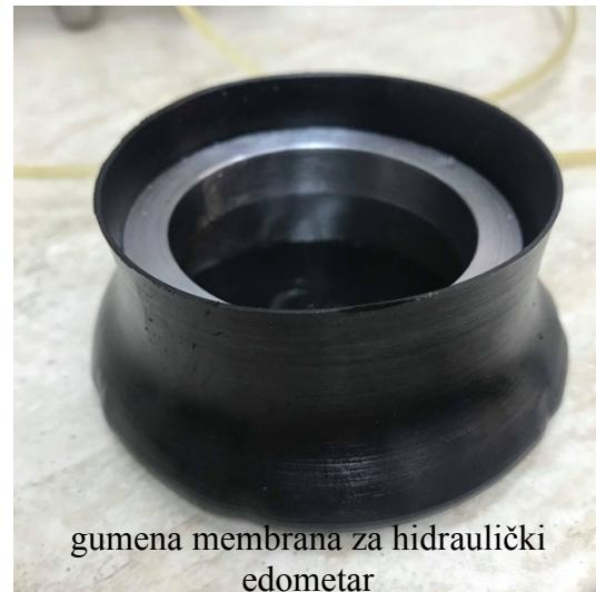
gumena membrana za hidraulički edometar
