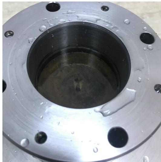
*Slika 29 Porozna pločica povrh uzorka rastavljene čelije s nakupljenom vodom (vode ovdje nije smjelo biti, već samo dizel)*
