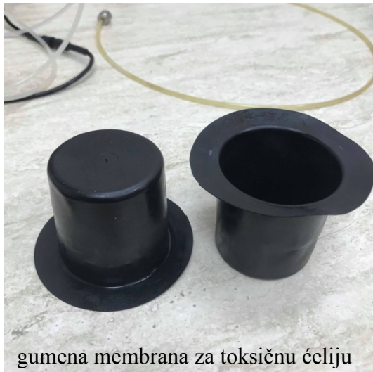
Slika 30 Usporedba gumenih membrani
