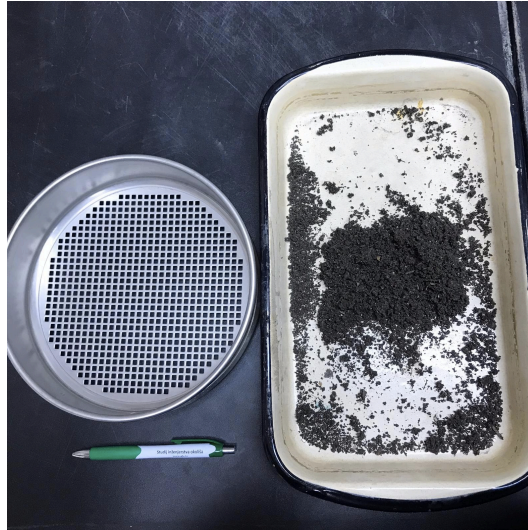
Slika 18 Uzorak humusa i sito promjera 4 mm
