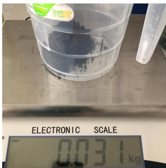
Slika 23 Masa uzorka koji se ugrađuje u hidraulički edometar
