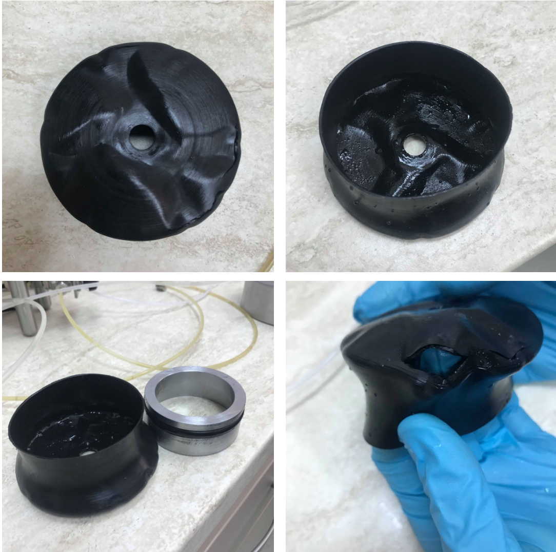
Slika 28 Deformacija i puknuće gumene membrane
