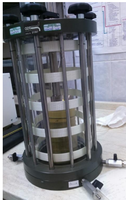
Slika 25. Ugrađen uzorak u triaksijalnoj ćeliji
