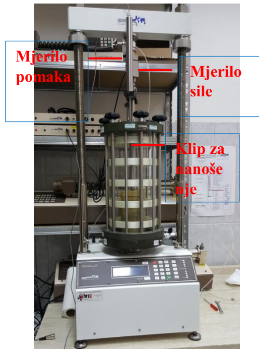
Slika 11a. Triaksijalna ćelija
