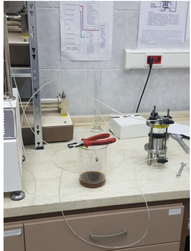
Slika 29. Toksična ćelija i procjedna voda iz uzorka
