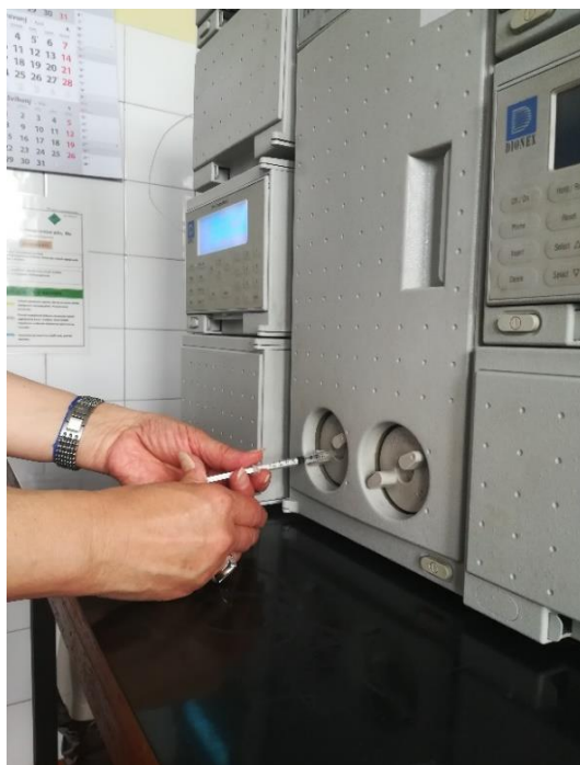
Slika 7. Injektiranje uzorka površinske vode kroz injekcijsku petlju ionskog kromatografa DIONEX DX-500
