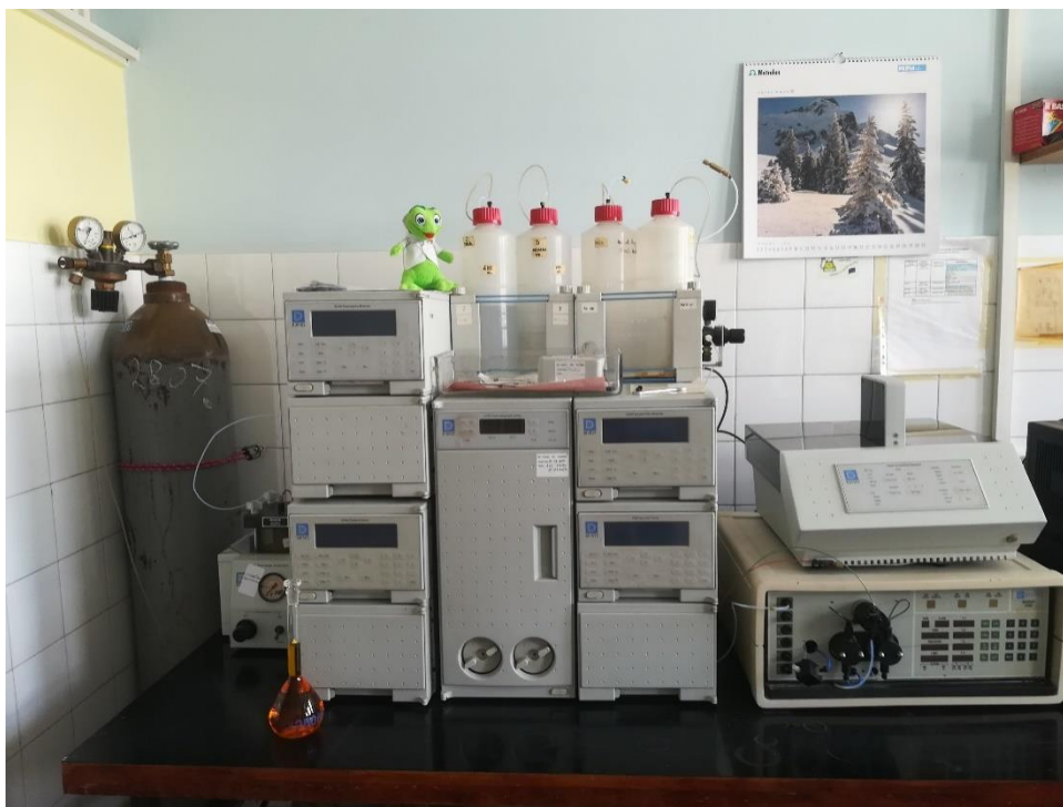
Slika 6. Ionski kromatograf DIONEX DX-500 (Thermo Scientific, SAD)
