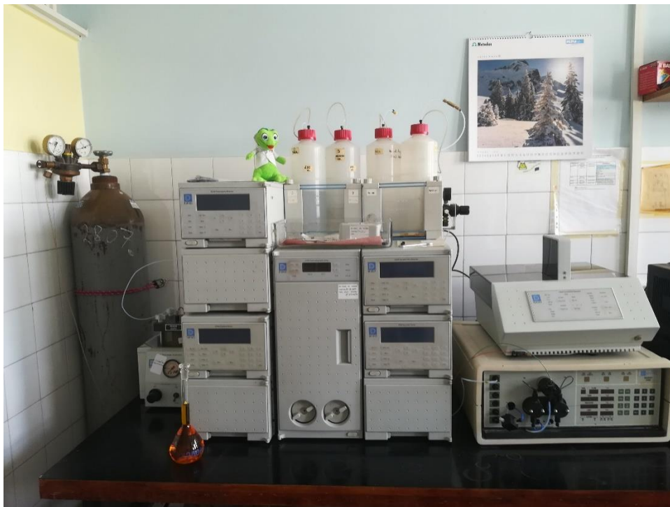
Slika 6. Ionski kromatograf DIONEX DX-500 (Thermo Scientific, SAD)
