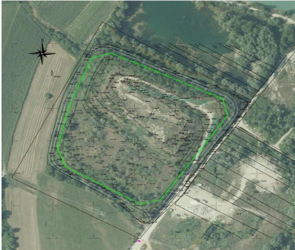
Slika 3. Dispozicija odlagališta Trebež i glinobetonske dijafragme [2]
