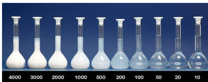
Slika 8. Vrijednosti mutnoće vode u NTU jedinicama [12]
