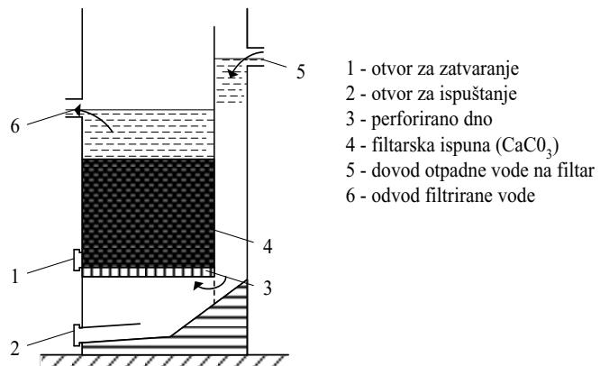
**Slika 18. Neutralizacija na filterskom sloju vapnenca [3]**
