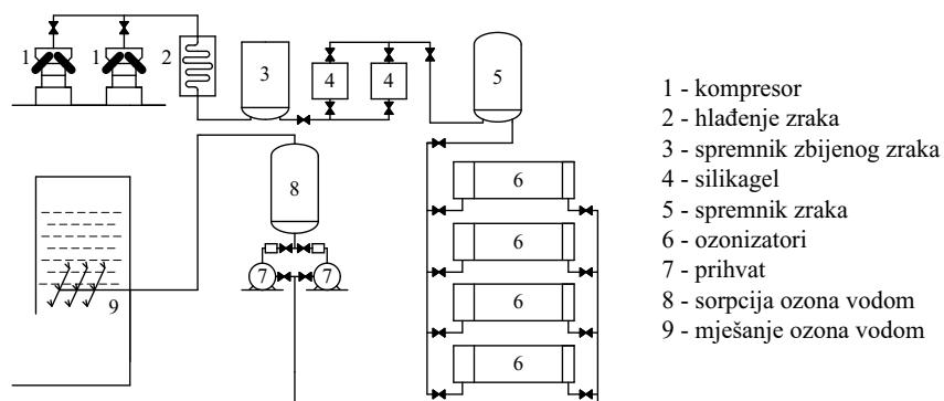
**Slika 21. Shematski prikaz uređaja za dezinfekciju vode ozonom [4]**
