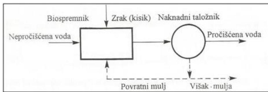
**Slika 26. Shematski prikaz postupka s aktivnim muljem [11]**
