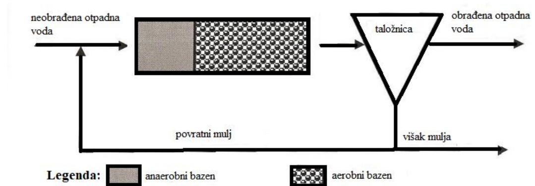
Slika 32. Uklanjanje fosfora [19]
