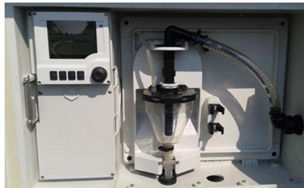
Slika 34. Automatski uzorkivač [33]
