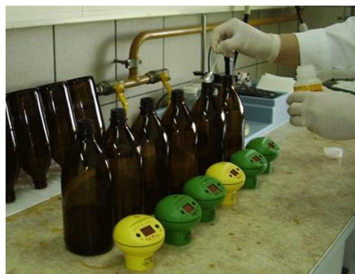
**Slika 39. Priprema uzorka za ispitivanje BPK<sub>5</sub> [33]**
