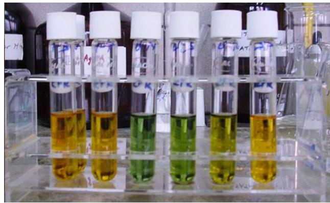
**Slika 37. Ohlađeni uzorci spremni za očitanje KPK vrijednosti [33]**
