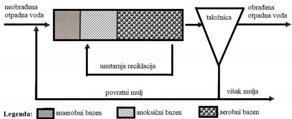
**Slika 33. Kombinirano uklanjanje fosfora i dušika [19]**
