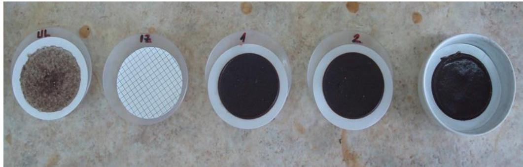
**Slika 40. Profiltrirani uzorci suspendirane tvari [33]**
