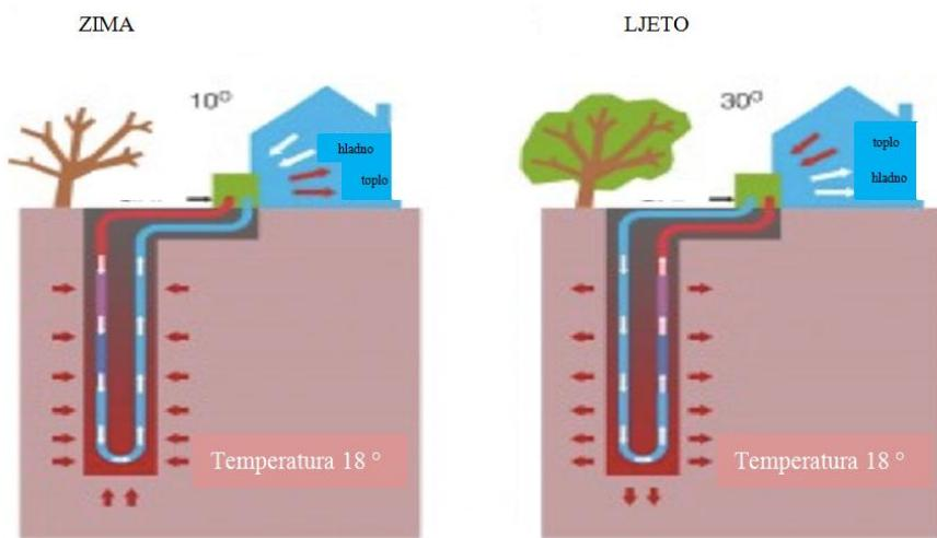
**Slika 18.**Prikaz izravnog korištenja geotermalne energije[28]
