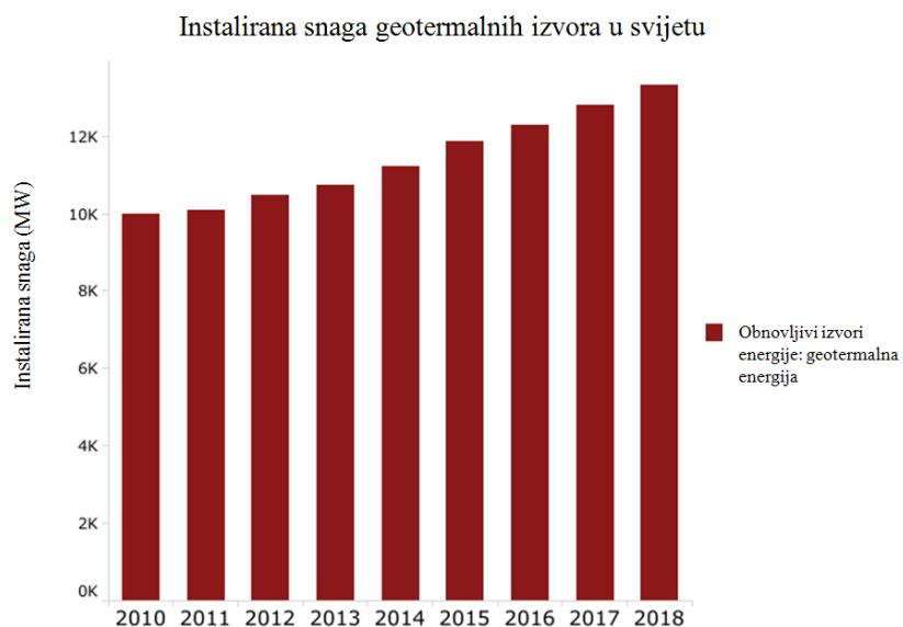
**Slika 20.**Prikaz instalirane snage geotermalnih izvora u svijetu
