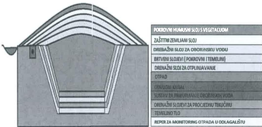
Slika 2. Poprečni presjek suvremenog odlagališta[4]
