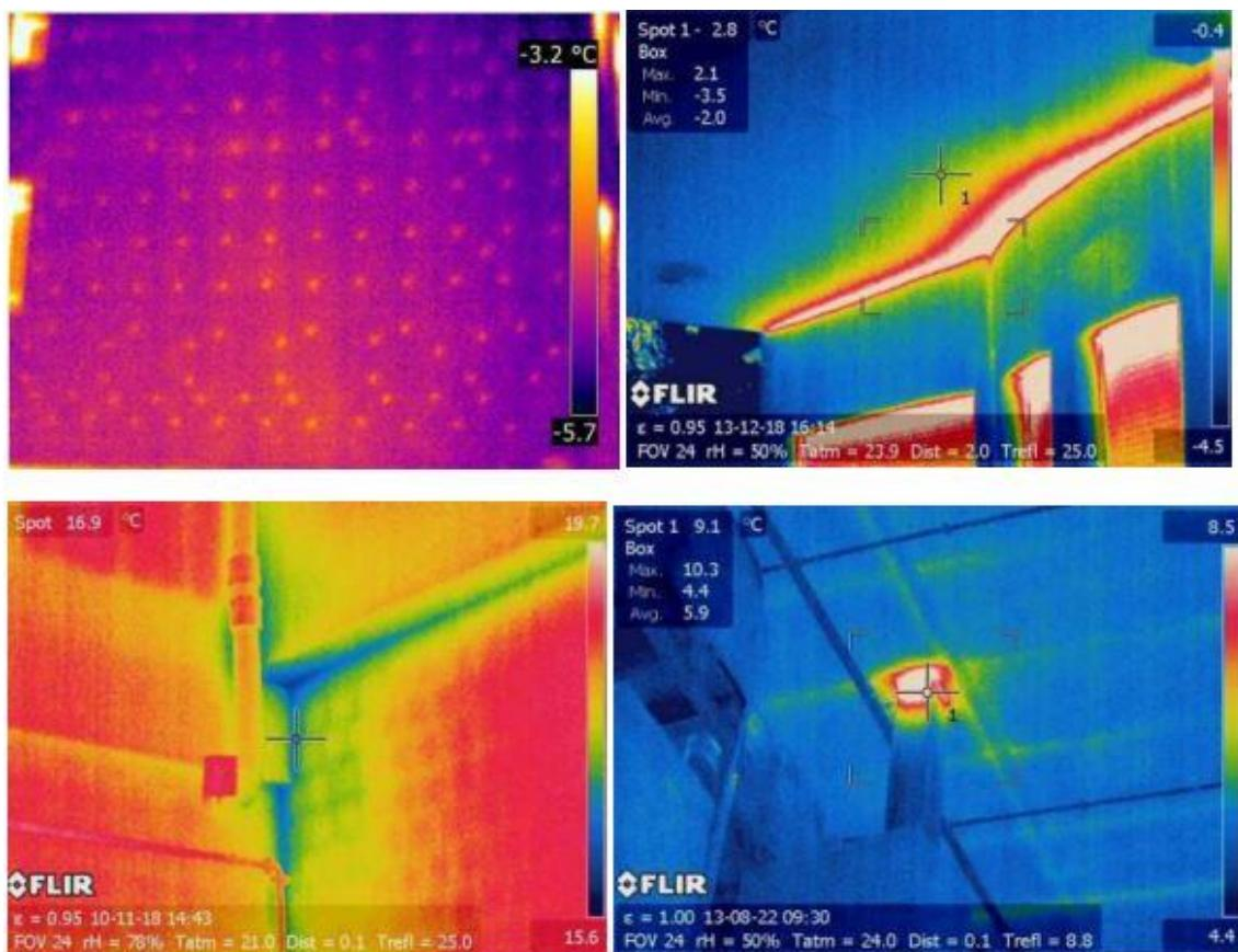
Slika 9. Točkasti, linijski, geometrijski i konstruktivni toplinski mostovi [15]
