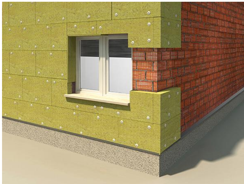
Slika 13. Fasada od kamene vune [22]
