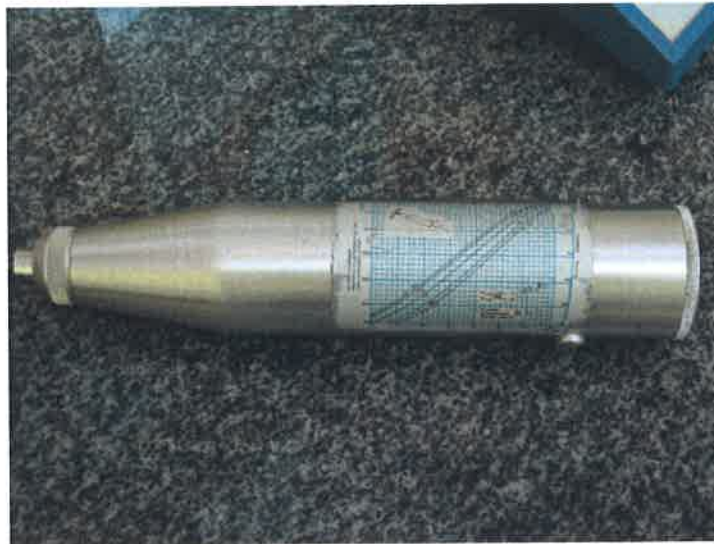
Slika 5. Schmidtov čekić (Strelec et al., 2013)
