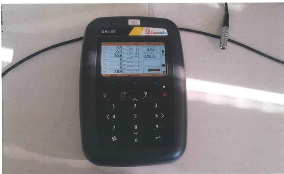
Slika 5 Prijenosni uređaj za mjerjenje odlagališnih plinova - GA5000
