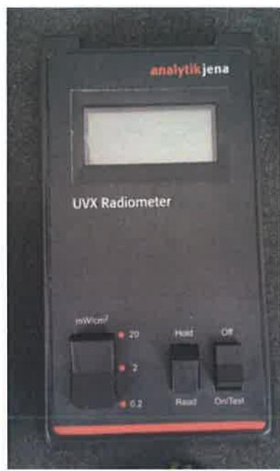
Slika 7 UVX radiometar Analytik Jena
