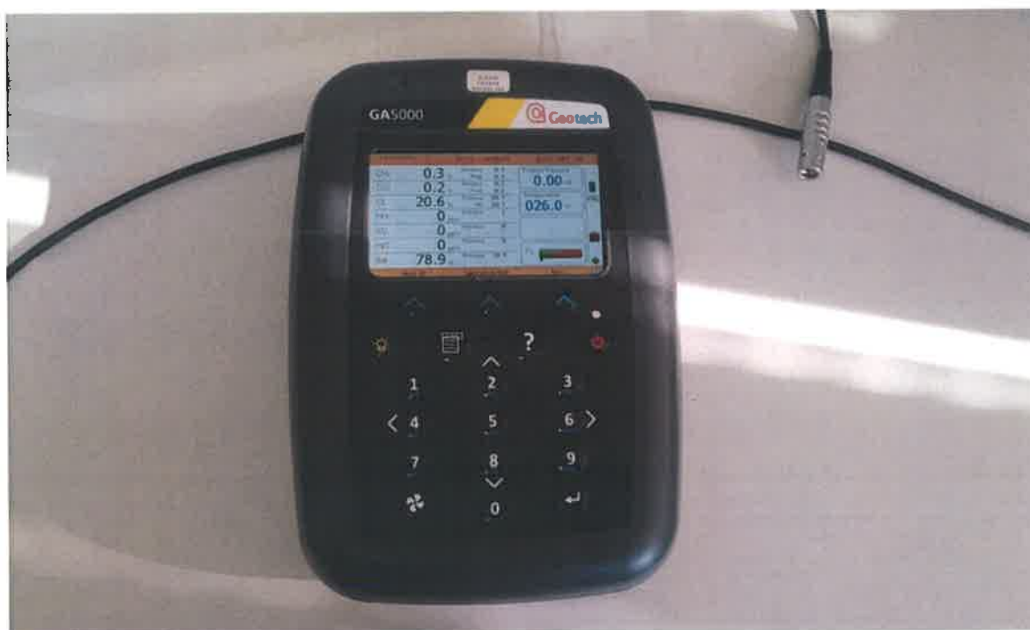
Slika 5 Prijenosni uređaj za mjerenje odlagališnih plinova - GA5000
