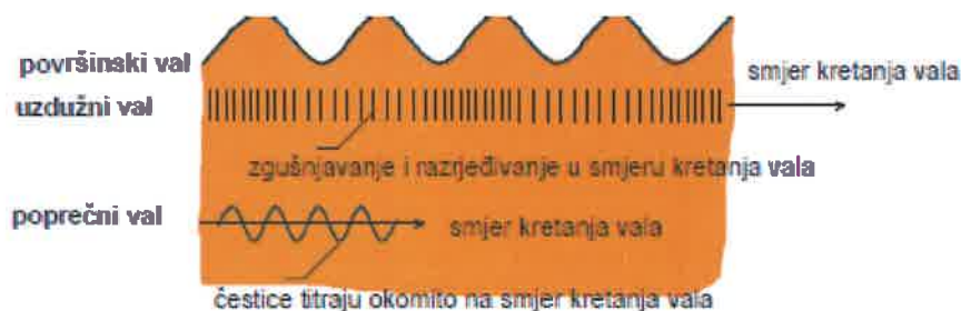
Slika 24. Vrste mehaničkih valova u tlu
