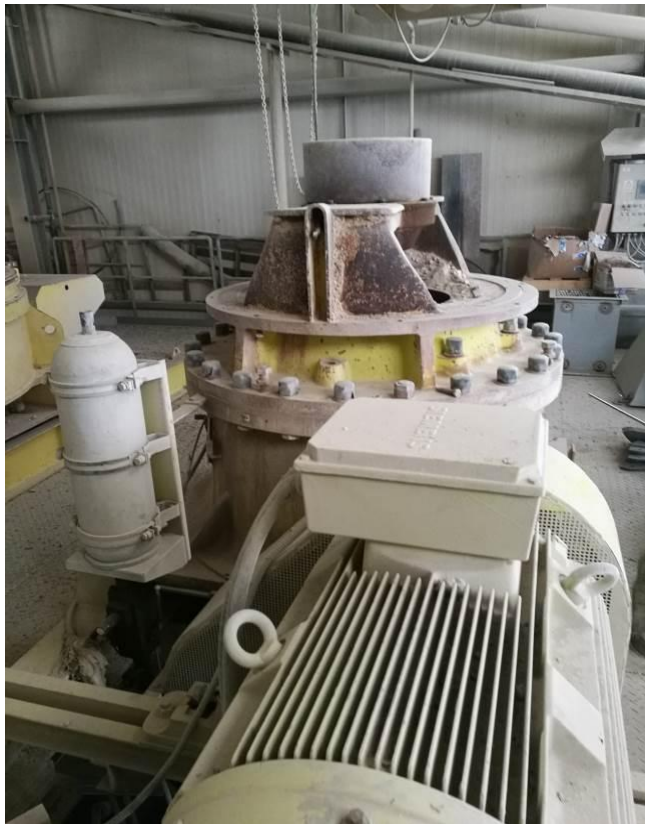
Slika br. 10: Drobilica Hydrokon KDH 900 [10]
